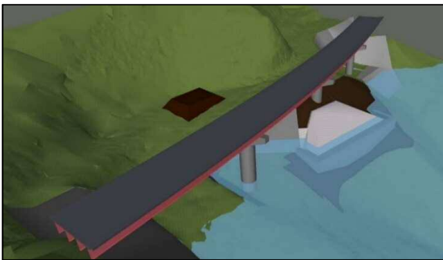
図-3 3Dモデルによる仮設道路検討
